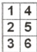
Obrázek 2: Rozložení bitů v buňce
